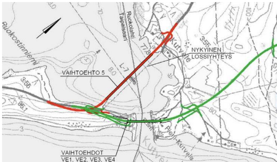
Kuva 4. Kyläniemen lossin korvaavat siltavaihtoehdot yleissuunnitelmassa (Kaakkois-Suomen tiepiiri 2009)
