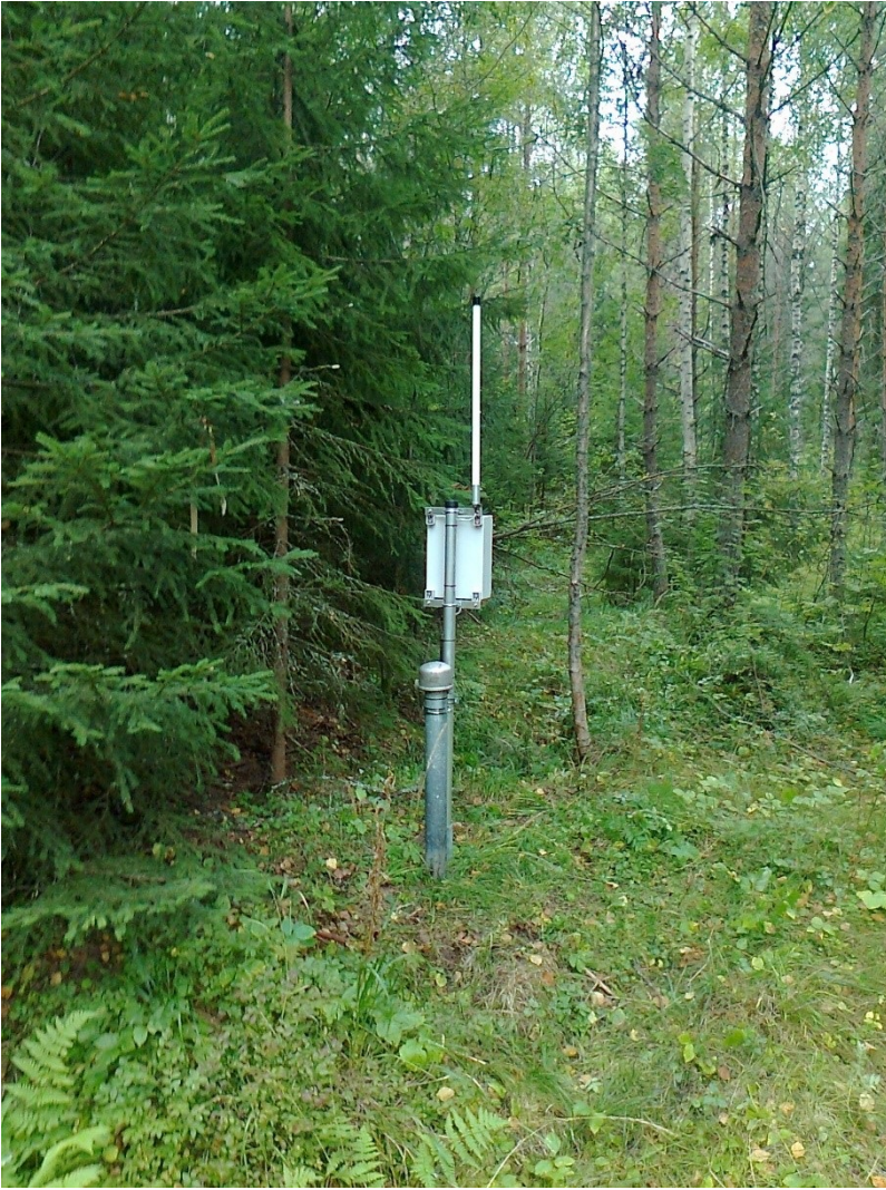
Esimerkkikuva automatisoidusta mittalaitteesta pohjaveden havaintoputkessa. © Juha Helin
