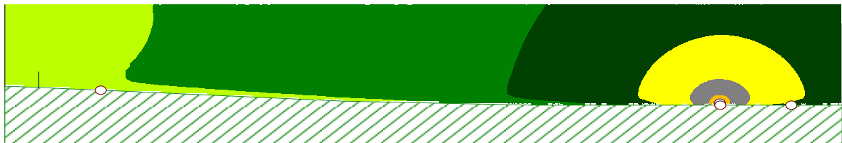
Kuva 1. Kuvassa Cadna A -mallinnuksen poikkileikkaus. Valkoinen pallo vasemmalla osoittaa kaavassa ehdotetun asuinalueen sijainnin ja oikealla olevat pallot kuvaavat tien kaistoja (ja melulähdettä).
